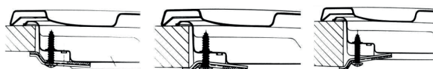
Posição do gancho para H=20mm Posição do gancho para H=30mm Posição do gancho para H=40mm
