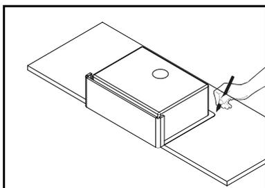
Após riscar a superfície usando a cuba como molde (A), risque novamente deixando um espaço (B), que pode variar conforme solicitação do cliente e/ou especificação do marmorista.
