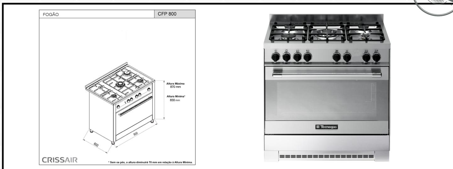
O Fogão de Piso italiano CFP 800 conta com queimadores italianos SABAF, 1 tripla chama de 3,5 kW, 1 rápido de 2,6kW, 2 semi rápido de 1,85kW e 1 auxiliar de 1kW. Produzidos em aço inox 304 com trespes de Ferro Gusa. O modelo conta com maxiforno multifunções elétrico com 85L, grill elétrico e sistema de segurança "Válvula Stop Gás".
