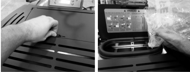
Figura 135 – Abastecimento do depósito de pellets
