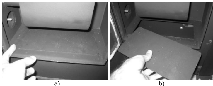
Figura 140 – Limpeza do interior da salamandra
