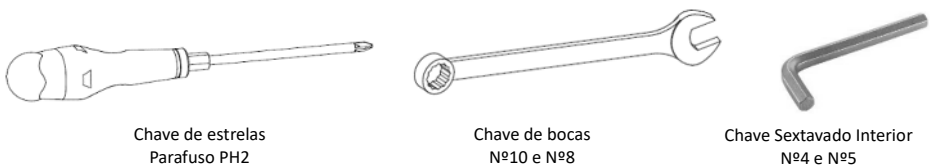
Figura 30 - Material necessário para a instalação das envoltivas junto a salamandra
