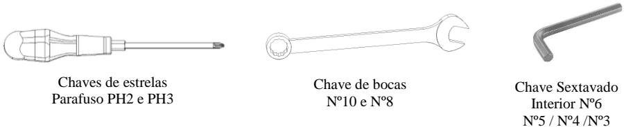
Figura 45 – Material necessário para a instalação das envolventes junto a salamandra.
