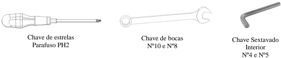
Figura 27– Material necessário para a instalação das envolventes junto a salamandra.
