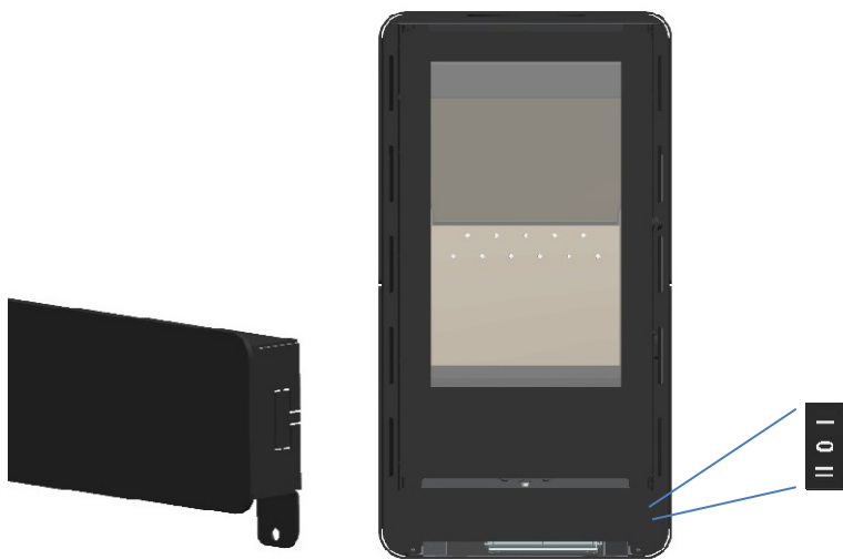
Figura 46 - Fixação do switch na tampa frontal
