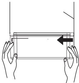
**Desmontagem:** Segure os dois lados da prateleira de garrafas com as duas mãos. Empurre-a do lado sem saliência e empurre-a para dentro conforme a direção da seta. Ao empurrar com força, observe que a fivela na borda da prateleira da garrafa é separada da ranhura do revestimento. Então a prateleira de garrafa pode ser removida.
